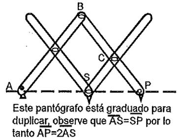
Con el pantógrafo, es posible obtener figuras semejantes a la original, cuyo contorno se sigue con la punta lectora P, en cualquier posición, dibujadas por el estilete S (reducir), pero si cambiamos el estilete S por la punta P, obtendríamos una copia duplicada.
